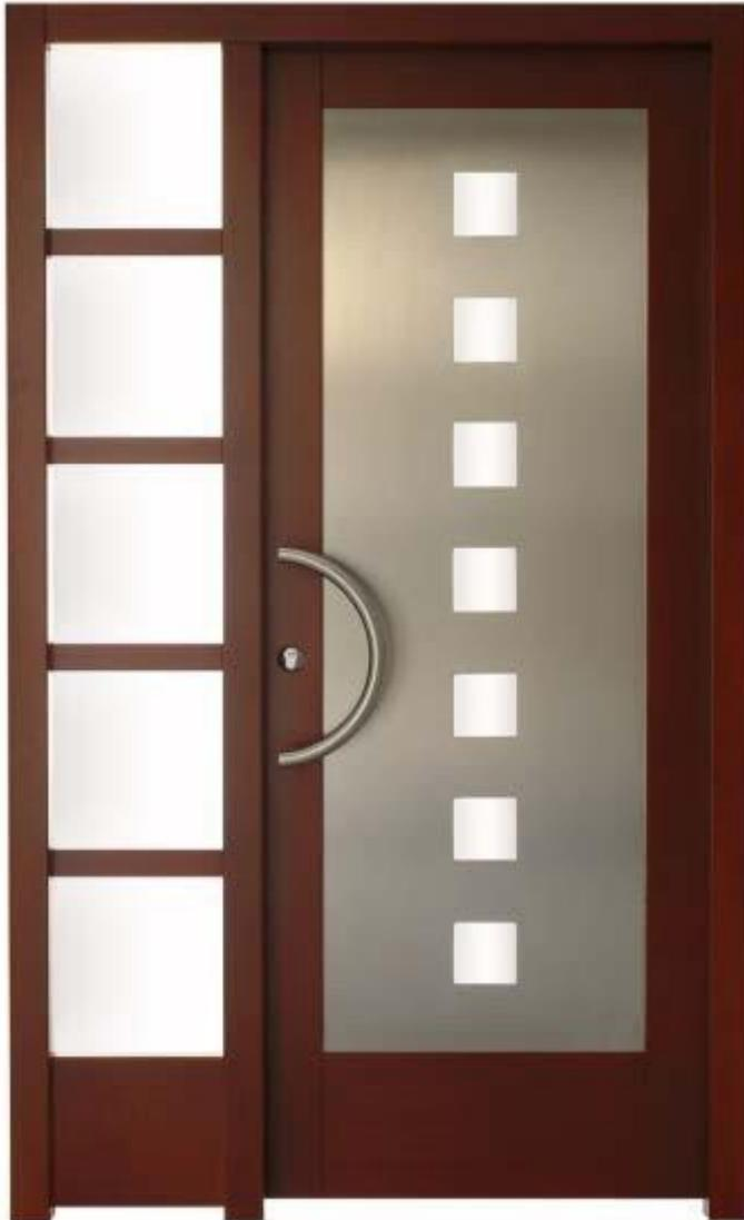
Puertas de entrada a viviendas en block de Roble liso, compuesta por: garce macizo visto de 70x30mm, con goma para estanqueidad, tapajuntas de roble macizo liso de 90x12mm, cerradura de seguridad de 3 puntos , 4 bisagras de seguridad, mirilla, momo , media manilla; instalado en obra y lacado, herrajes acabados en acero inox satinado.
