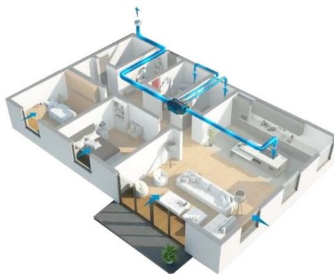
El mencionado sistema de ventilación mecánica controlada garantiza la calidad del aire del interior de las viviendas, mediante la renovación del aire viciado por uno limpio de manera continua y controlada.
