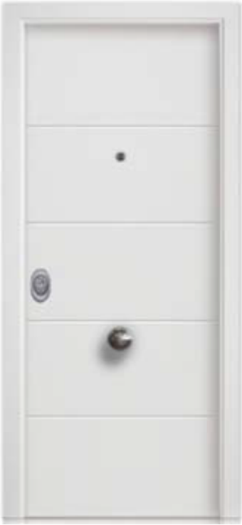
Puerta de acceso a vivienda blindada en madera lacado en blanco, con cerradura 3 puntos, bisagras antipalanca, pomo, mirilla, bocallave y manivela
