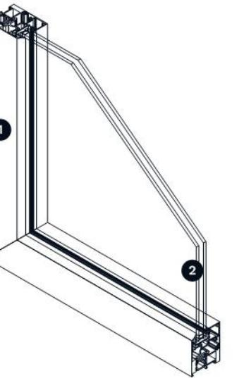
1 Perfil aluminio con rotura de puente térmico
