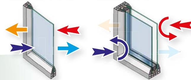
ción. Esto se debe a que el perfil interior de la ventana está por debajo del punto de rocío y hace que aparezcan esas gotas que "sudan" de la ventana. La Rotura del Puente Térmico eleva la temperatura superficial de la parte interna y de esta manera se reducen las posibilidades de condensaciones o lo que comúnmente llamamos "sudar".
